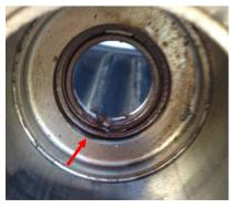
é localizado o alojamento do retentor de alta pressão, que a usinagem na parte inferior (seta) do alojamento do retentor apresenta uma folga excessiva e falta de paralelismo, o que gera um desalinhamento do conjunto e a um esforço mecânico excessivo exercido pelo eixo no retentor durante seu movimento rotacional e o consequente rompimento do lábio do retentor na mesma região, ocasionando o dano e a falha na vedação.
